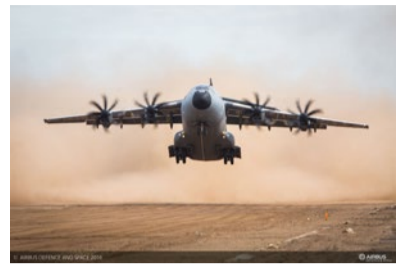
L'A400M, lancé en mai 2003, effectue son 1 er vol en décembre 2009. Essais d'atterrissage sur terrain non préparé (2016)
