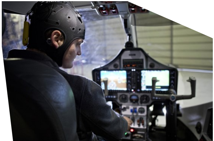
Expérience en simulation de vol avec mesure de l'activité cérébrale
