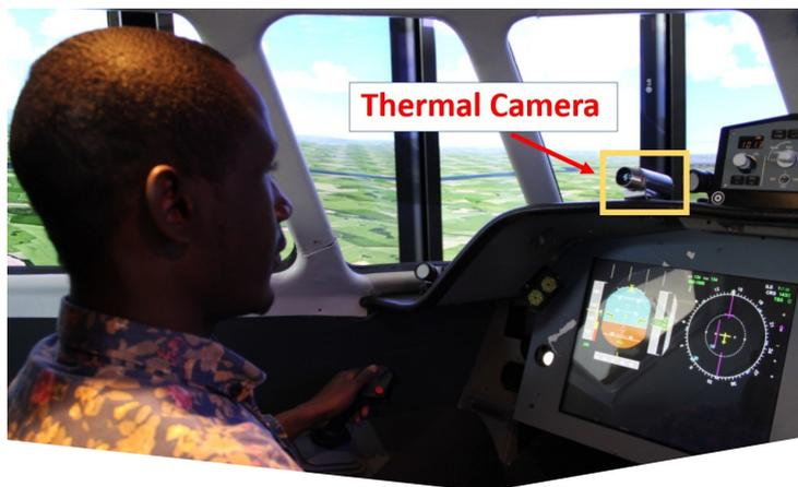
Une assistance qui nécessite de détecter la fatigue, la baisse de vigilance, le stress, la distraction ou même une confiance excessive dans les automatismes. Pour cela, des dispositifs tels que l'oculométrie (eye-tracking), la mesure de température du visage ou l'électrocardiogramme peuvent être mis en œuvre.
